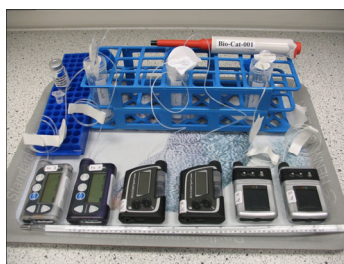
Studien set-up: Pumpen Animas, Accu-Chek u. Medtronic mit Kathetern und Auffanggefäßen
